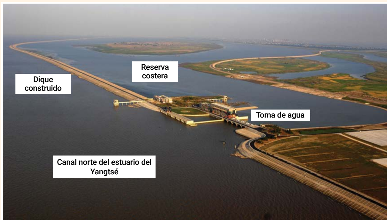
Figura Vista aérea del embalse costero de Qingcaosha en la desembocadura del río Yangtsé
